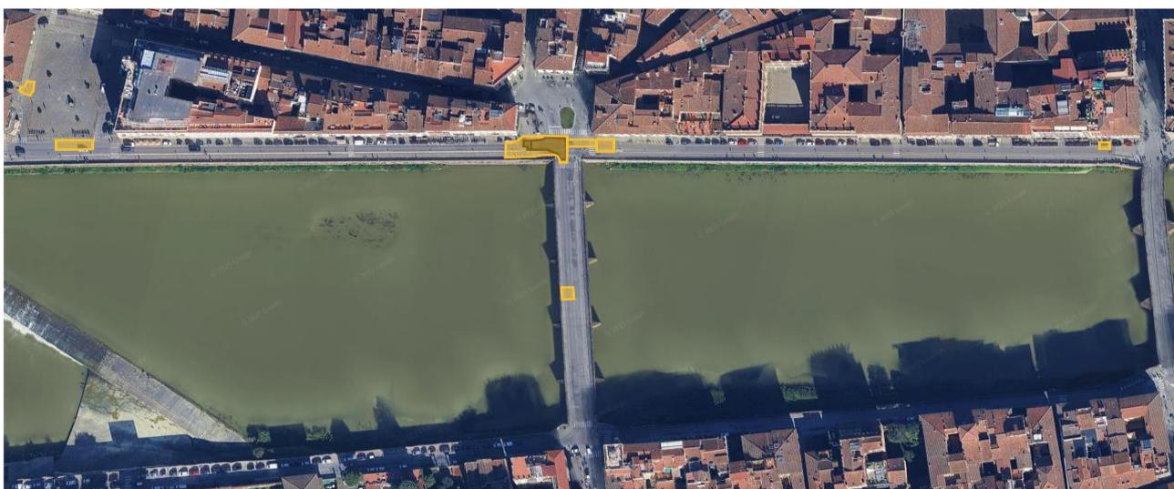
L'intervento prevede l'apertura di 6 scavi, ovvero gli "scavi di rilancio" necessari per il relining delle due tubazioni DN 300 sul ponte alla Carraia e di una tubazione DN 600 tra piazza
