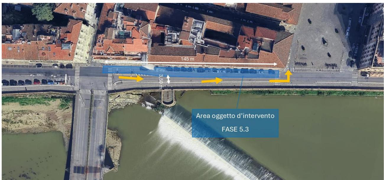
Posa condotta DN100 e realizzazione allacci. Avanzamento del cantiere verso ponte Vespucci. Si prevede un restringimento di carreggiata senza interruzione del traffico.
