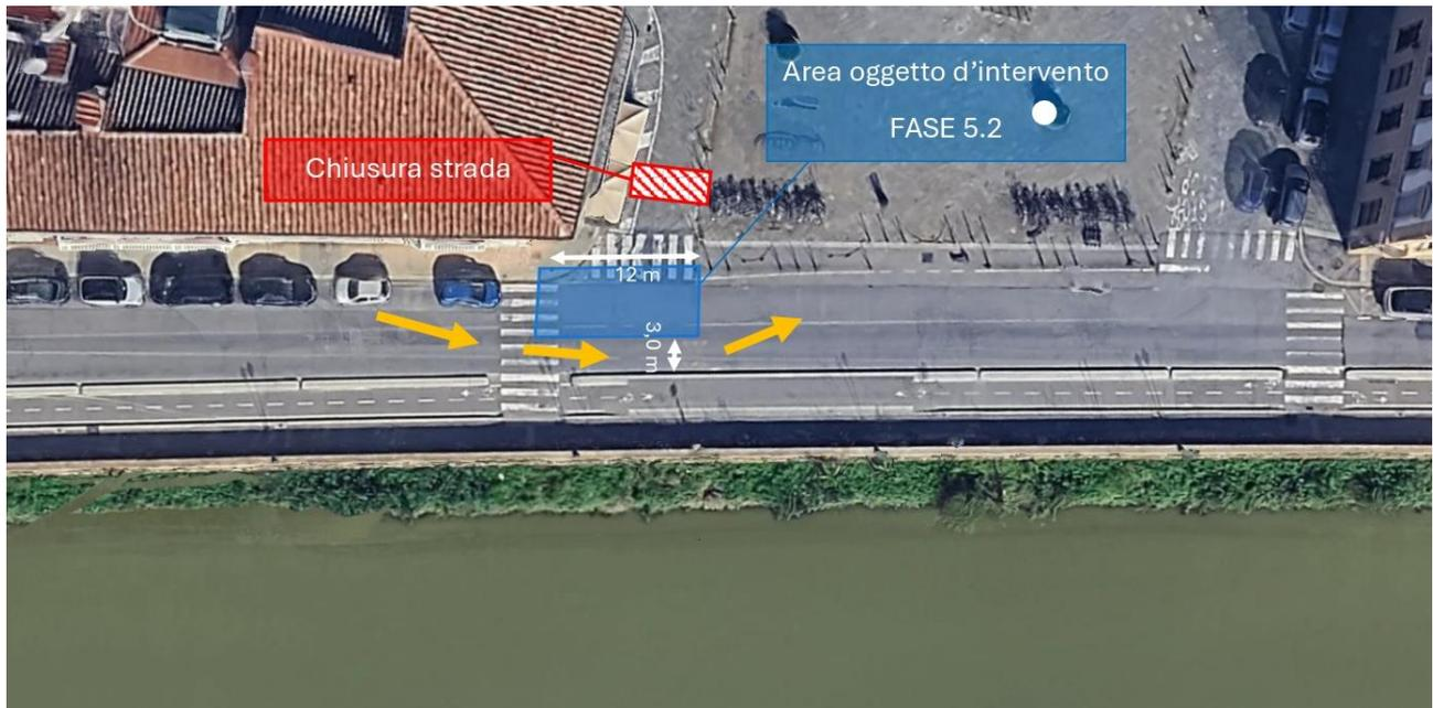
Posa condotta DN100. Avanzamento del cantiere verso ponte Vespucci. Si prevede un restringimento di carreggiata senza interruzione del traffico. Necessari 2 giorni lavorativi per effettuare l'intervento.
