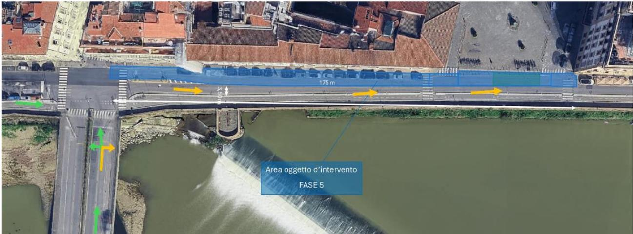
Intervento per la posa della condotta DN100 e la realizzazione degli allacci. Il cantiere avanzerà in direzione ponte Vespucci con restringimento di carreggiata senza interruzione del traffico.
